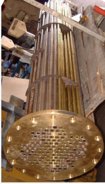
Neues Rohrbündel angefertigt
